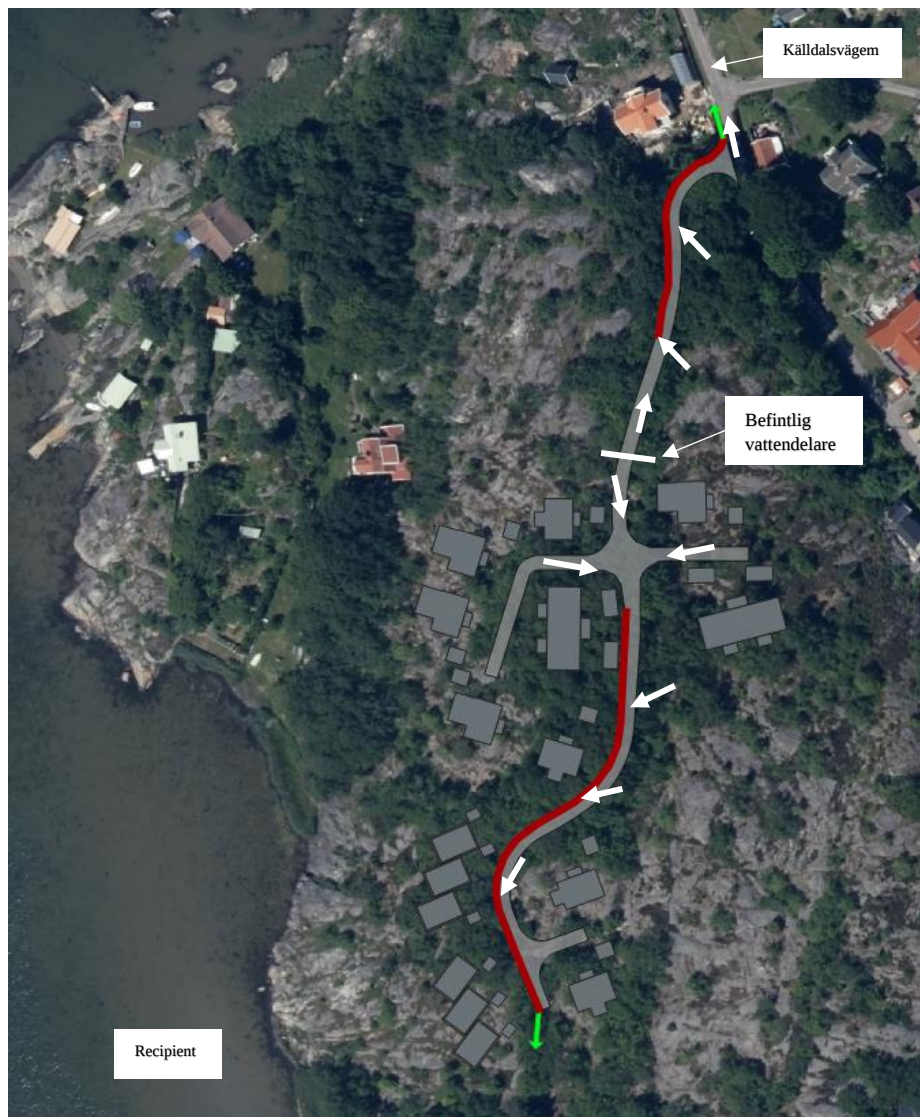
Figur 20. Principskiss för lösningsförslag i Område A. Vita pilar motsvarar lokalvägens föreslagna lutning, vitt streck motsvarar område för befintlig vattendelare, röda streck motsvarar område för makadamdike och gröna pilar utlopp från makadamdike.
