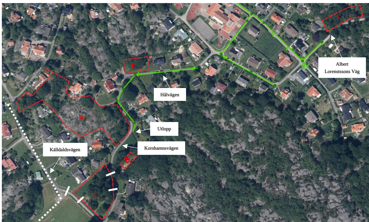
Figur 9. Dagvattenledningar för planområdet. Gröna linjer motsvarar ledningar. Gröna cirkclar motsvarar brunnar. Vita linjer motsvarar trummor och vita prickade linjer motsvarar anlagda dagvattendiken. Planområdets gränser visualiseras med röstreckade polygoner.
